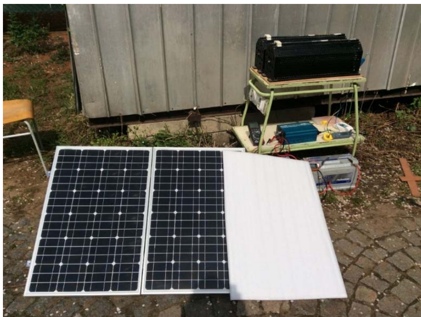
Obr. 24: Vertikální zastiňování kolektoru
