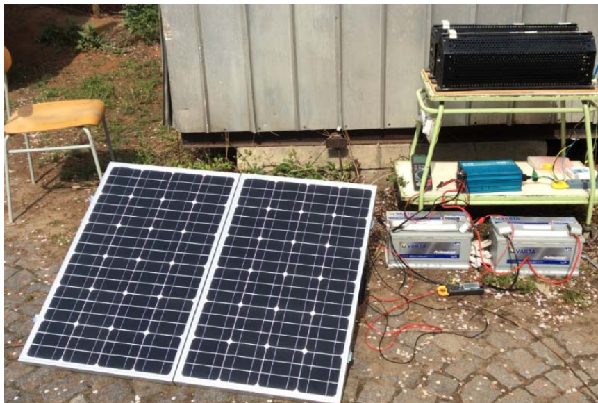
Obr. 23: Zapojení pracoviště v praxi a měření nezastíněného kolektoru
